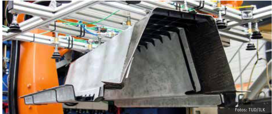
Die Bodengruppe aus dem Projekt LEIKA kombiniert Stahl, FVK, Magnesium und faserverstärkte Spritzgussteile.
