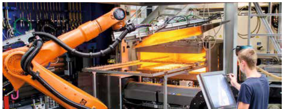
Im Prozess-Entwicklungszentrum am ILK setzten die FOREL-Wissenschaftler den im LEIKA-Projekt konzipierten kombinierten Press- und Hinterspritz-Prozess um.
