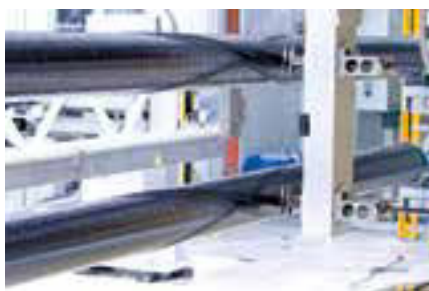
Abb. 4: Fertigung am Zwei-Spindel-Wickelautomat
