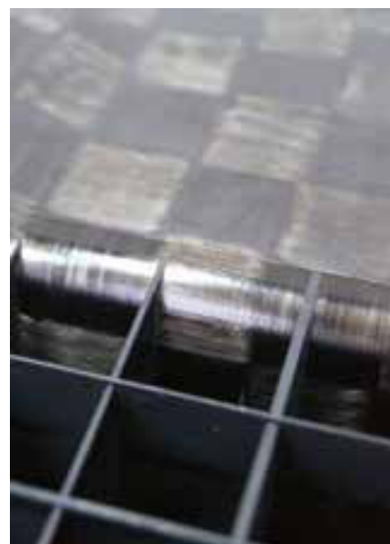
Thermogeformtes Gewebe-Organoblech mit hinterspritzter Rippenstruktur
