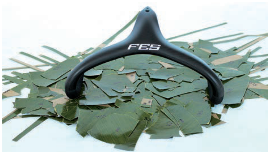
Das Ergebnis einer numerischen Bauteiloptimierung, der Sprintlenker SL11 – ein Puzzle aus 136 Einzelteilen
