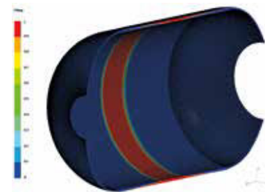
Abb. 3: Vorhersage der Fließfrontausbreitung durch 3D-Finite-Elemente-Simulation des dickwandigen, gewickelten Demonstrators.
