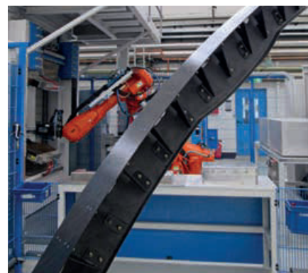
Thermoplastspant mit integrierten Verstärkungselementen in der Fertigung
