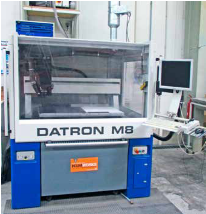
Drei-Achs-Fräsmaschine Datron M 8, speziell optimiert für die Composite-Bearbeitung Datron M8 three axis milling machine specially optimised for machining composites
