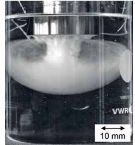
Ausbreitung der Kavitationszone von Epoxidharz in einem Becherglas
