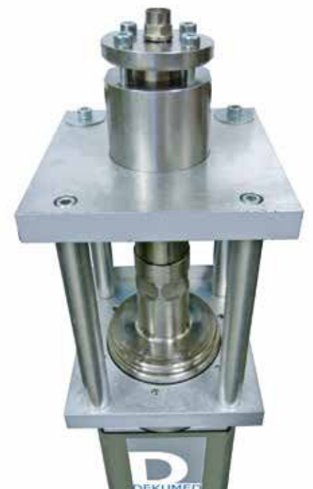
Prototypen-Mischkopf mit Mischkammer und Ultraschallkonverter
