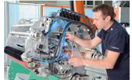
Abb. 3: Gesamtsystem für die automatisierte Blitzschutzablage
