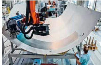
Abb. 1: Rumpfschale während der automatisierten Ablage von Blitzschutz
