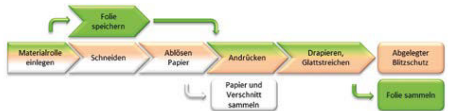
Abb. 2: Automatisierter Ablageprozess für Blitzschutz
