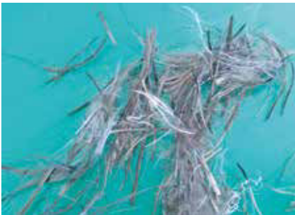
Abb. 1: Carbonfaserrezyklat nach einstufigem Reißprozess
