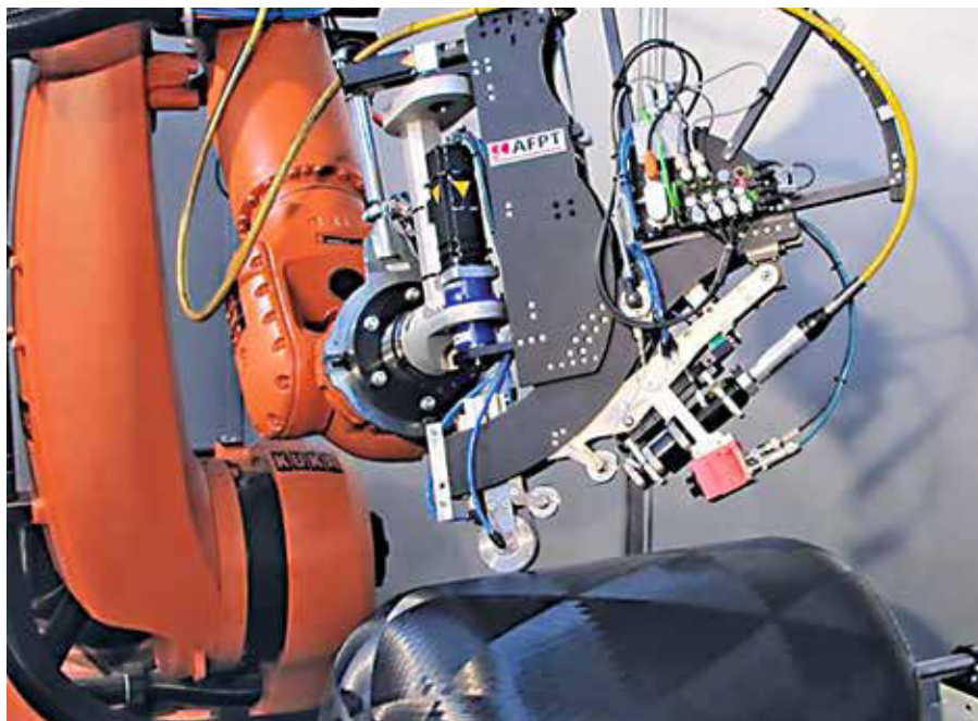
Laserunterstützter Tapewickelkopf zum schnellen Wickeln eines thermoplastischen Druckbehälters
