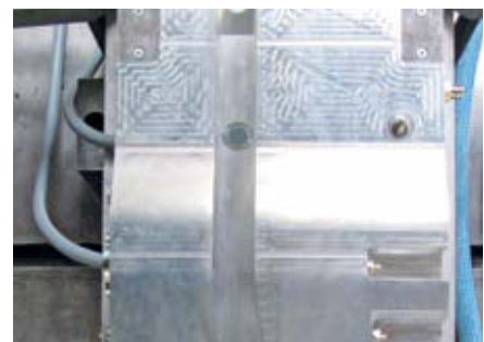
Integrierter Dielektrik-Sensor im Fertigungsprozess
