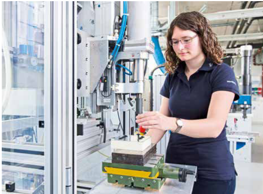
Einbringen spezieller Kunststoffschrauben in Sandwichmaterial
