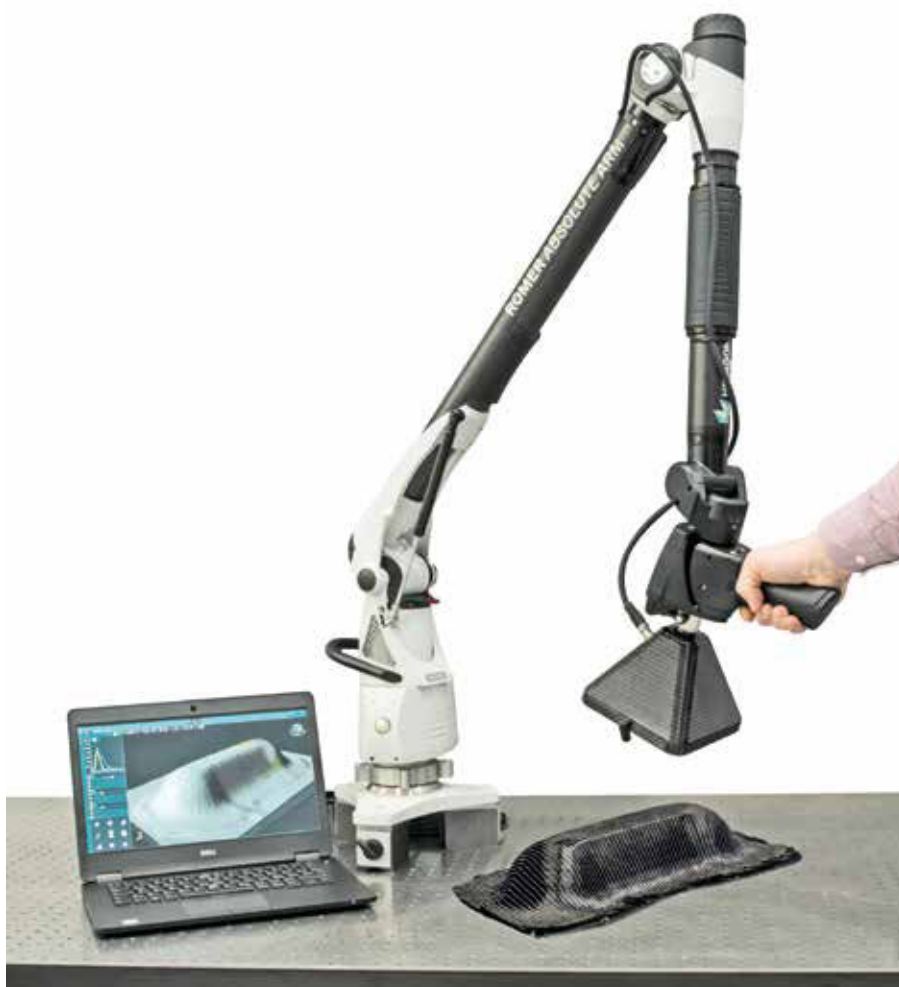
AVS 3D: handgeführtes Messsystem zur Bauteildigitalisierung, Fehlerdetektion und Soll-Daten-Abgleich
