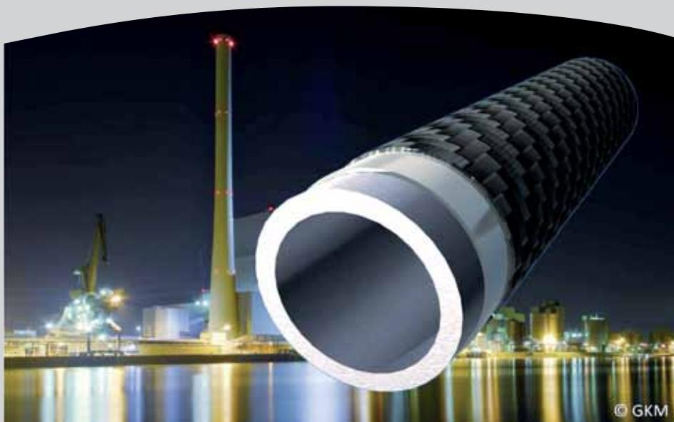
Konzept eines heißgasbeaufschlagten Compoundrohres: Stahlrohr mit Zwischenschicht und Keramik-Mantel. (Bildquelle Hintergrund: GKM; Rohr: Fraunhofer ISC)
