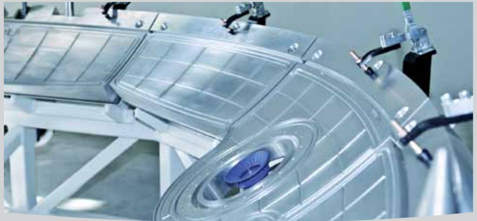
Befräsvorrichtung A350 XWB Druckkalotte
