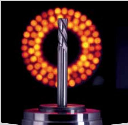
*Spiralisiertes PKD-Werkzeug, aufgespannt in der Messtechnik von Hufschmied*
