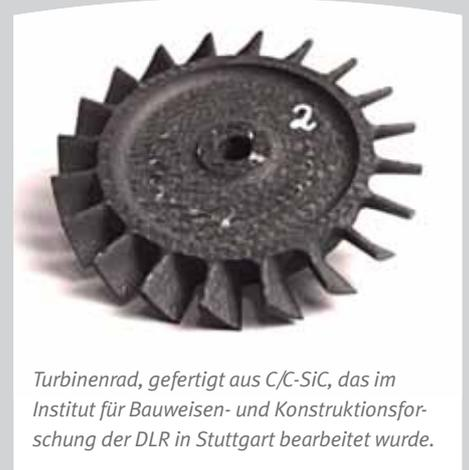
*Turbinenrad, gefertigt aus C/C-SiC, das im Institut für Bauweisen- und Konstruktionsforschung der DLR in Stuttgart bearbeitet wurde.*
