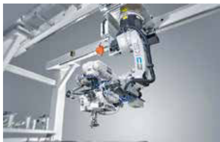
Die CNC-Nähanlage KL 110 kann auf 8 m x 3,5 m mit Doppelsteppstich Kohle- und Glasfasergelege im 2D-Bereich vernähen.
