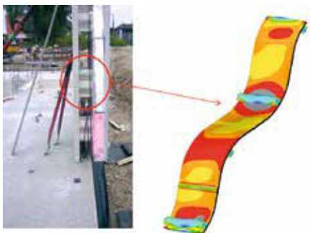
Abb. 2: GFK-Welle im eingebauten Zustand (li.) und Dehnung der GFK-Welle unter Scherbelastung (re.)
