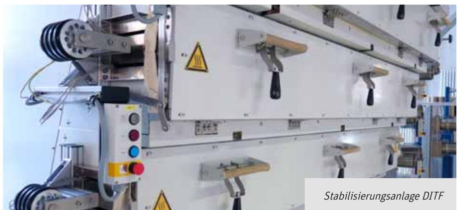
Lignin durch chemische Funktionalisierung in Kombination mit weiteren Polymeren eine mechanisch stabile Präkursorfaser zu entwickeln. Hierzu wird ein in Denkendorf entwickeltes, kostengünstiges Schmelzspinnverfahrens angewendet. In weiteren Schritten wird die Präkursorfaser im Endlosverfahren stabilisiert und karbonisiert.
