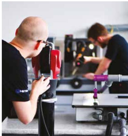
Mit modernstem Equipment (Leica AT960-XR mit T-Probe und T-Scan 5 sowie API Radian mit vProbe) und einem hoch qualifizierten 3D-Messtechnik-Team können wir **mobil** vielfältige Messungen sowohl vor Ort bei unseren Kunden durchführen, als auch **stationär** in unseren eigenen Prüfhallen an den Standorten in Stade und Augsburg (inkl. klimatisiertem Messraum).
