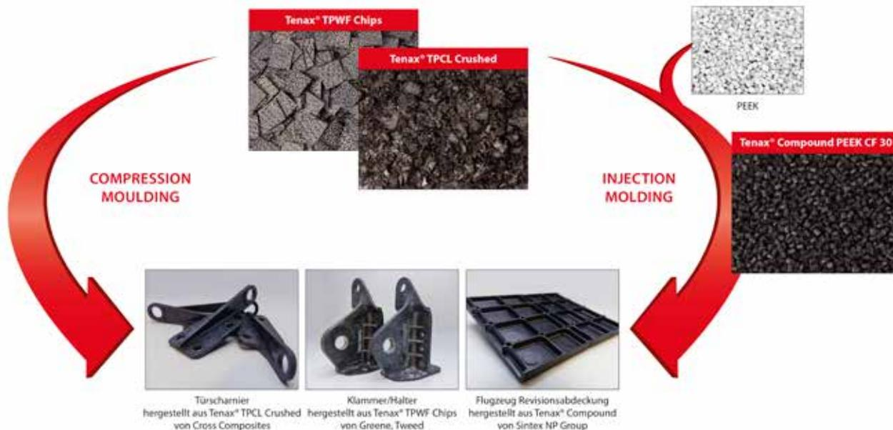
Thermoplastische Halbzeuge ermöglichen schnelle Bearbeitungszeiten bei hoher mechanischer Leistung. Tenax®-E ThermoPlastic Consolidated Laminates (TPCL) sind konsolidierte Laminare aus mehreren Lagen ThermoPlastic Woven Fabric (TPWF). Sie sind für den Einsatz in „Clips und Klammern“ im neuen Airbus A350XWB qualifiziert.
