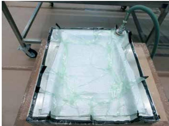
*Verformung eines ThermHex-Wabenkerns mittels Vakuumsackverfahren*
