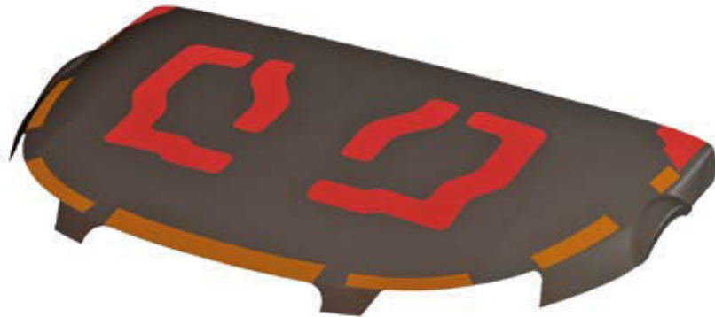
Variotherme Klebewerkzeuge mit unterschiedlichen Heizzonen und Temperaturprofilen (beispielsweise rot T = 140\text{ °C} und orange T = 80\text{ °C} )
