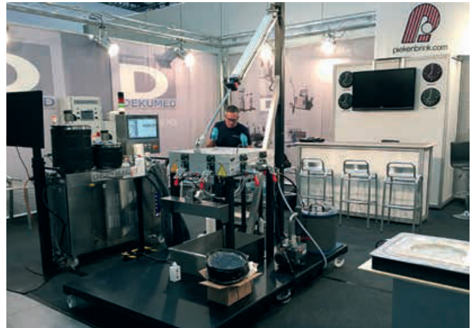
Werkzeugträger mit Injektionsanlage Process infrastructure including injection machine
