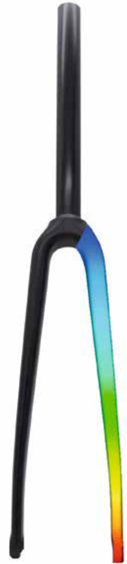
Ergebnisse der Finite-Elemente-Modellierung und Prototyp einer Fahrradgabel
