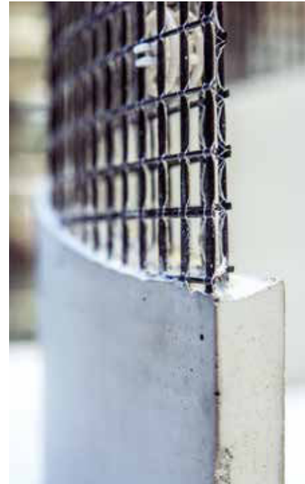
Schlanke Lösung: Abstandhalter trennen zwei Lagen Carbongitter, dazwischen kann der Beton einfließen
