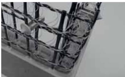
*3D-Textilbewehrung mit positionierten Abstandshaltern im teilbetonierten Muster.*
