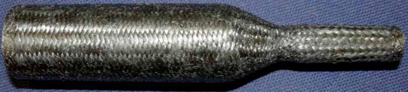
Abb. 4: CMC-Mikrobrennkammer (C/C-SiC) für Heißgas-Test im ERBURIG Prüfstand
