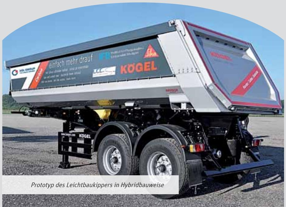
Prototyp des Leichtbaukipper in Hybridbauweise
