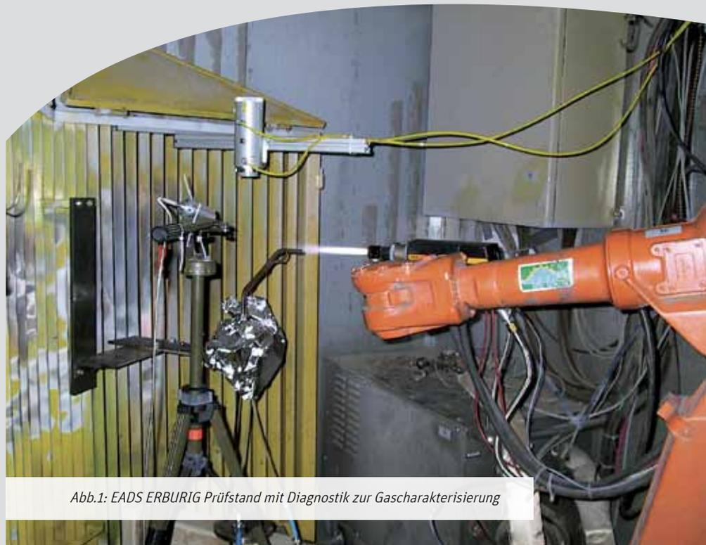
Abb.1: EADS ERBURIG Prüfstand mit Diagnostik zur Gascharakterisierung
