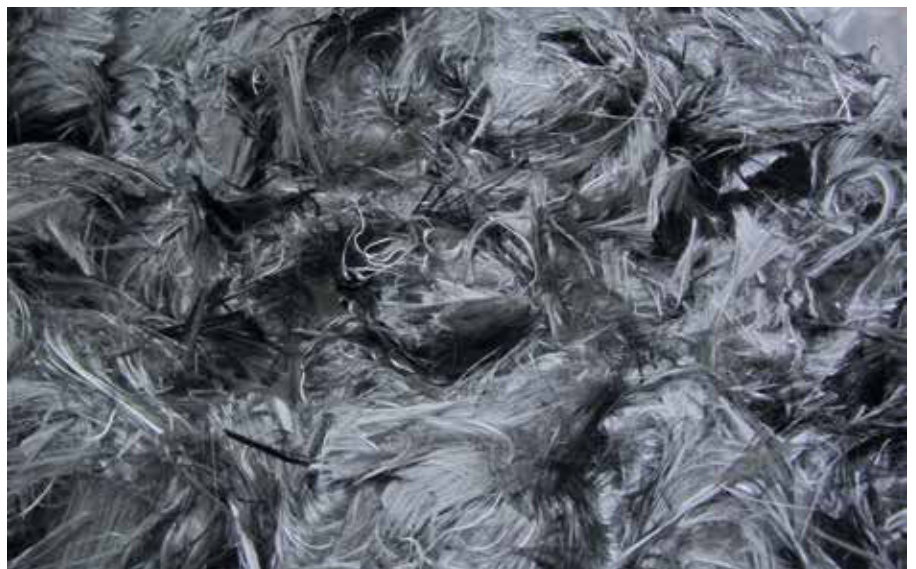
Recycelte Carbonfasern aus der Pyrolyse mit weißen Nähfäden
