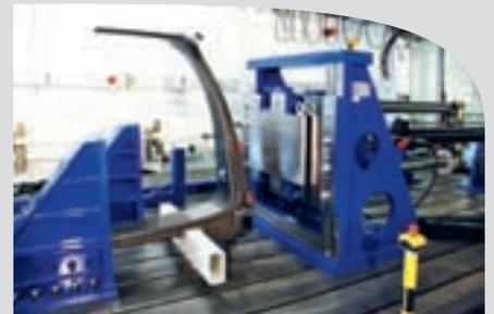
Quasi statische Vorversuche einer Ringspantstruktur aus Faserkunststoffverbund
