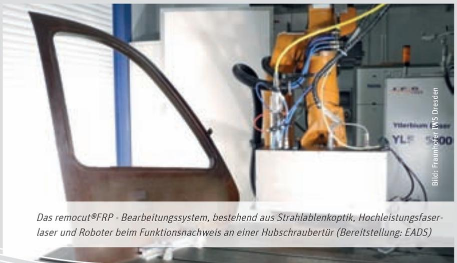
*Das remocut®FRP - Bearbeitungssystem, bestehend aus Strahlablentoptik, Hochleistungsfaserlaser und Roboter beim Funktionsnachweis an einer Hubschraubertür (Bereitstellung: EADS)*
