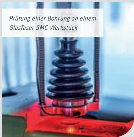
Prüfung einer Bohrung an einem Glasfaser-SMC-Werkstück
