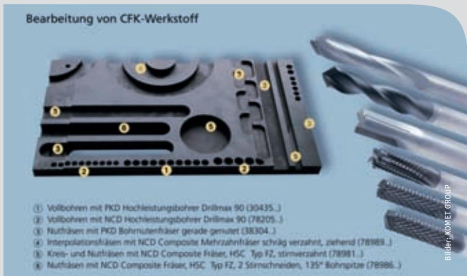
Ob Vollbohren oder Nutfräsen – das KOMET®-Standardprogramm für den Leichtbau hat für jeden Einsatzfall das passende Werkzeug.
