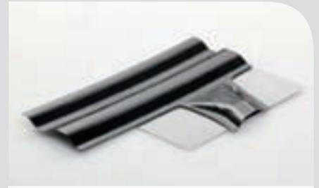
*Halbmodell Dachspiegel, hergestellt an der IVW GmbH mittels Direktablage*
