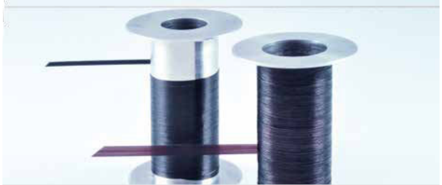
Bereits hergestellte Fertigungsmuster (links: 3mm CF-PA6 / rechts: 6mm BF-PA6)
