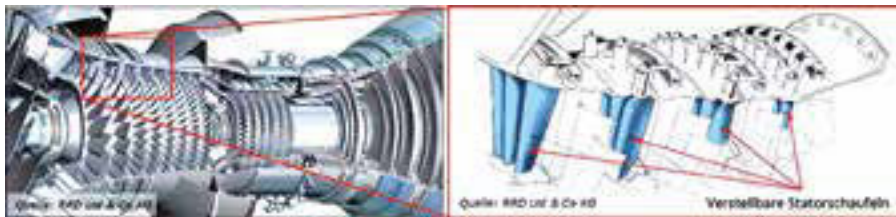
Position der stehenden verstellbaren Verdichterschaufeln im Triebwerk
