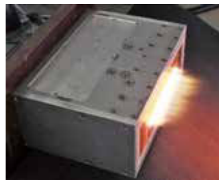
Abb. 3: Large-Plasmaquelle zur Hochrate-Plasmaaktivierung
