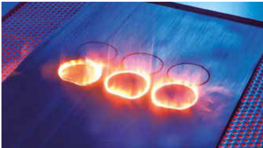
Abb. 1: Laserzuschnitt von thermoplastischen CFK-Prepregs mittels remocut®FRP-Technologie
