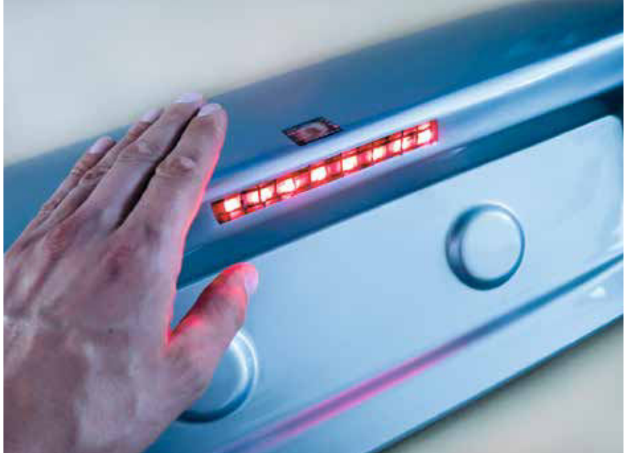
Im Projekt TEMAG entwickelte Fahrzeug-Heckklappe, die im Spritzgießverfahren mit Endlosfaserverstärkung und Funktionselementen hergestellt wird. Der Technologieträger ist mit einem Touch-Sensor und einer Bremsleuchte ausgestattet.
