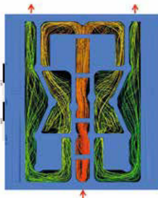
Abb. 3: Strömungssimulation der großflächigen Temperierung im Unterwerkzeug
