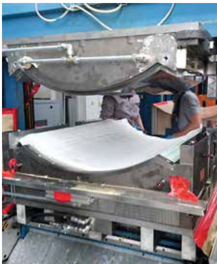
Abb. 1: Eingelegte Preform (Lagenaufbau) im neuartigen Werkzeug
