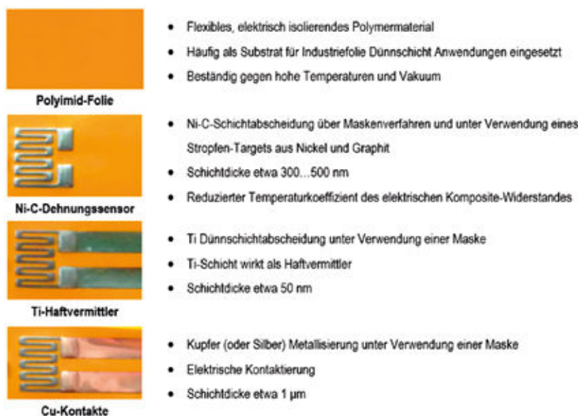
Abb. 1: Herstellungsrouten der Ni-C-Dehnungssensoren mittels DC-Magnetron-Sputterprozess
