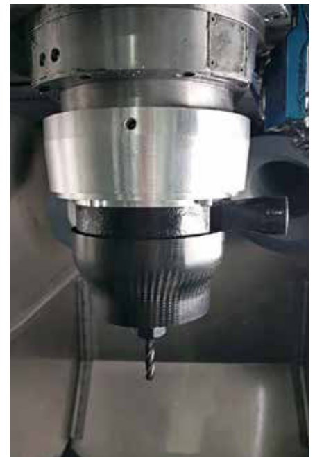
Hybrides CFK/Metall-Werkzeugspannfutter mit integrierter Luftabsaugung in einer CNC Werkzeugmaschine (BMBF-Forschungsprojekt MAI Span, Spitzencluster MAI Carbon)
