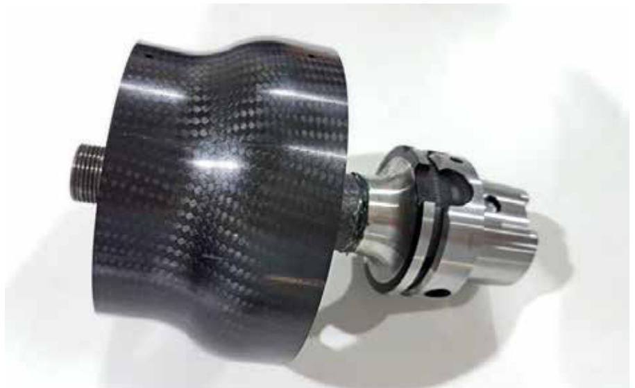
Rotor des hybriden CFK / Metall Werkzeugspannfutters mit integrierter Luftabsaugung (BMBF-Forschungsprojekt MAI Span, Spitzencluster MAI Carbon)
