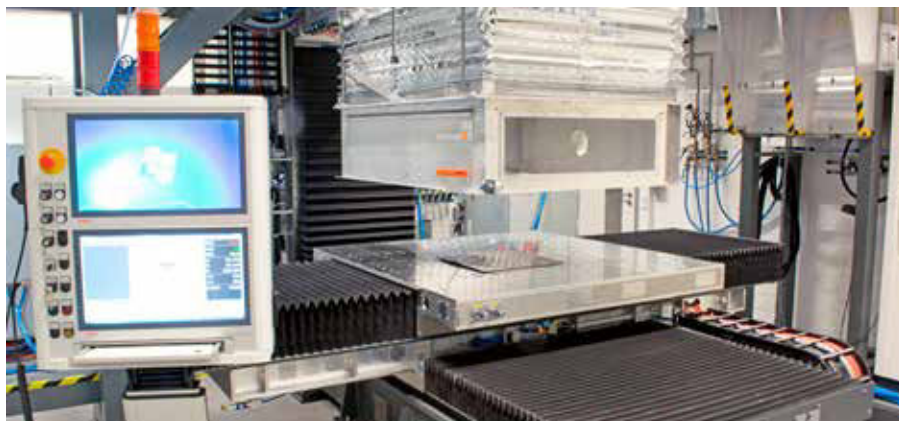
Multi-Remote-Anlage zur Großflächenbearbeitung mit Laserstrahlung und Atmosphärendruckplasma
