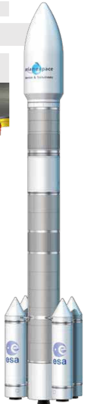
Boostergehäuse, Länge 12 m, Ø 3,3 m
