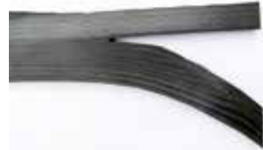
Infusion von Druckbehälter und Schürzenanschluss
