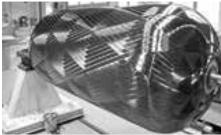
Entwicklungstestkörper mit trocken abgelegtem Fasergelege, vor der Infusion
