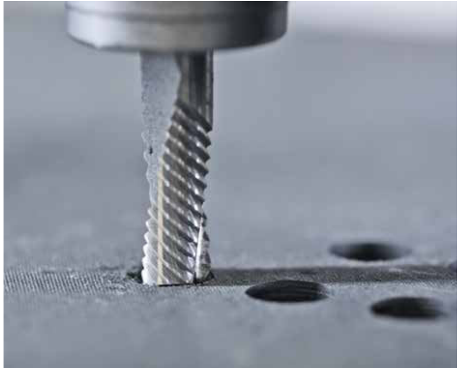
Beim Fräsen von CFK-Komponenten ist es vor allem wichtig, Delamination zu vermeiden.
