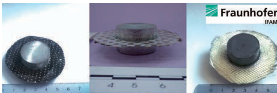
Abb. 1: Auswahl an pulvermetallurgisch hergestellten Metall-FVK-Verbindungsmodulen: Aluminium-Basaltfaser; Aluminium-Glasfaser; Eisen-Glasfaser (v.l.n.r.)
