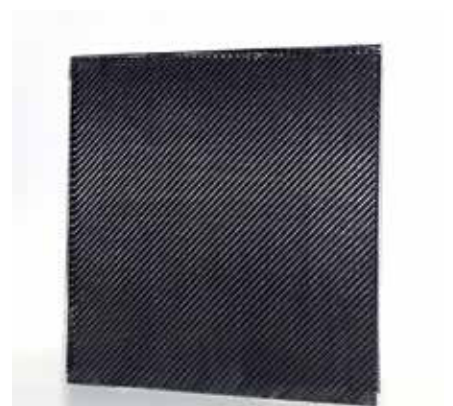
Abb. 3: Im Resin Powder Moulding-Verfahren gefertigte CFK-Platte für eine Anwendung im Sichtbereich
