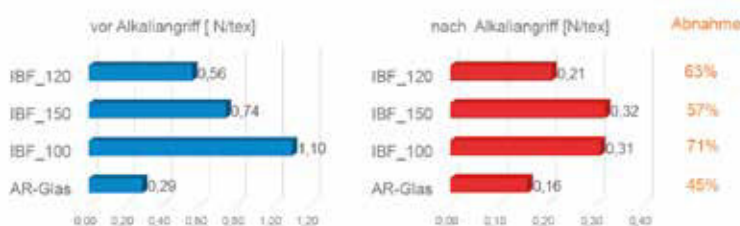
Abb. 1: Vergleich der tex-bezogenen Zugbruchkraft vor und nach Alkaliangriff (1 mol NaOH, 40 °C, 28 Tage)
