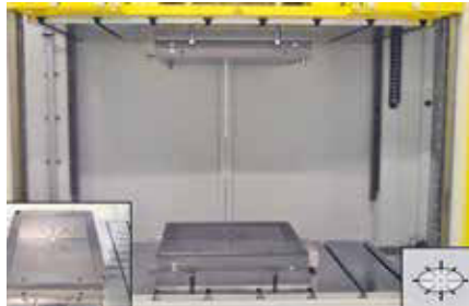
Kapazitives Permeameter an einem hydraulischen Formenträger zur ebenen Permeabilitätscharakterisierung.
