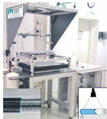
Optische Bestimmung der axialen Permeabilität von Flechtschläuchen.
