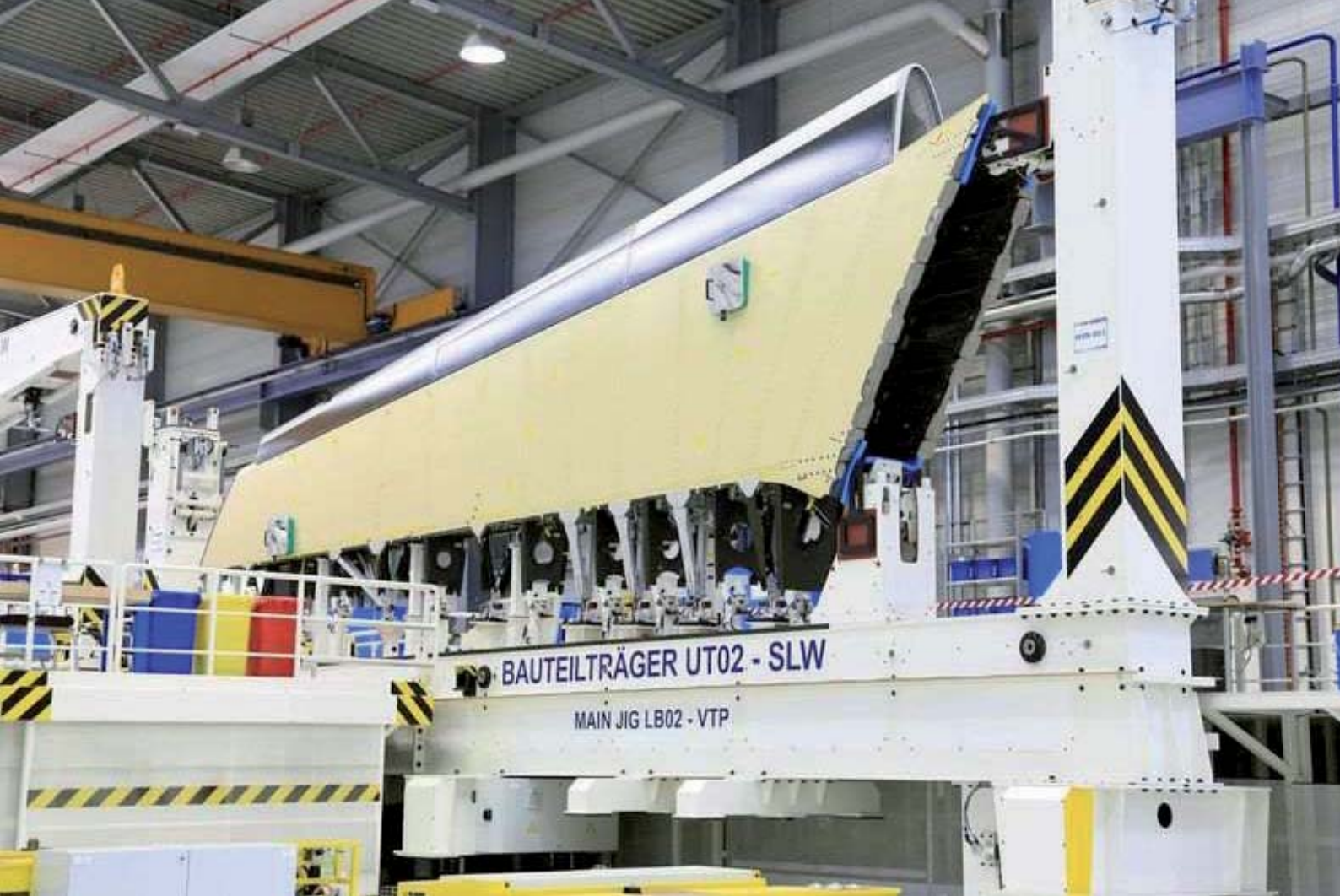
Montage des Seitenleitwerks für den A350XWB Assembly of the vertical tailplane for the A350XWB
