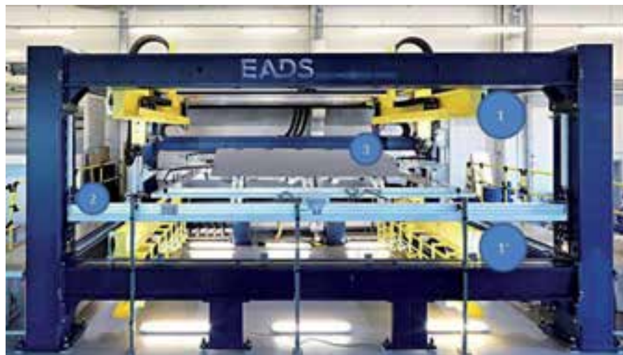
Abbildung 5: Prototyp einer vollständig flexiblen Anlage zur Armierung von Schaumwerkstoffen im CFK-NORD – (1) & (1') korrespondierendes Achsenpaar; (2) Probenhalter auch für gekrümmte Teile; (3) 3D geformtes Bauteil zur Armierung (© EADS Deutschland GmbH)
