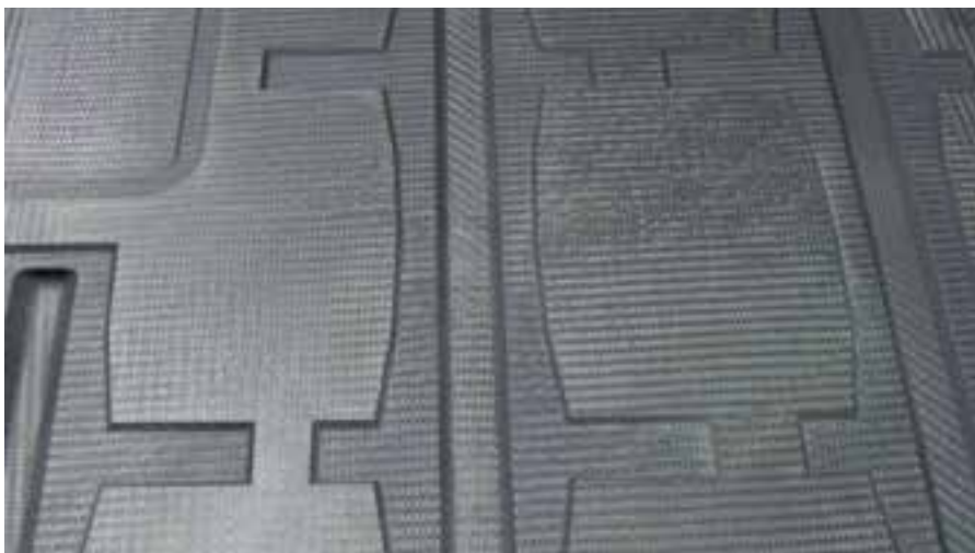
Abb. 4-Maschinell nachbearbeitetes Beta-Prepreg unter Verwendung von polykristallinen Diamant-Schneidewerkzeugen
