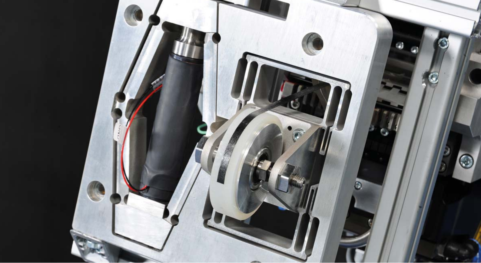
Abbildung 2: Struktur des adaptiven Systems aus piezoelektrischem Aktuator, Andruckrolle und spiel- sowie reibungsfreier Kraft-/Wegübertragung durch Festkörpergelenke zur Kompensation von Bahnfehlern
