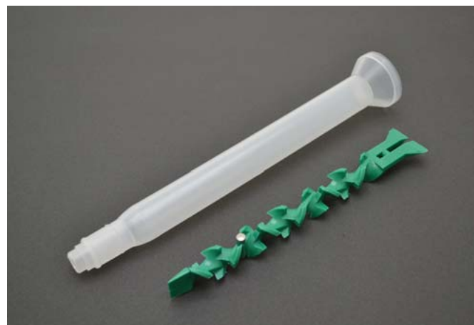
Viele Mischer im Sortiment von Tartler verfügen über segmentierte Spiralen und verkürzte Leitschaufeln; sie sind daher ausgelegt für extreme Viskositätsunterschiede und Mischungsverhältnisse.
