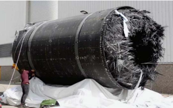
Abb. 2: Demonstratorgehäuse nach erfolgreichem Struktur- und Bersttest. Quelle: MT Aerospace
