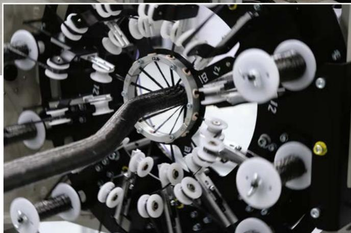
Null Ondulation die Faserfestigkeit besser ausgenutzt als bei herkömmlichen Wickelverfahren. Durch die Erzeugung vollständiger Wickellagen in nur einem Schritt, können so die Zykluszeiten zur Herstellung entsprechender Bauteile erheblich reduziert werden.
