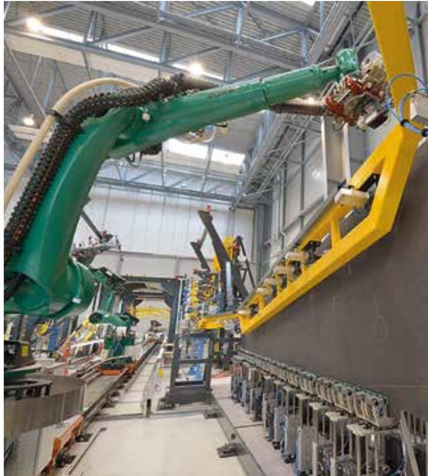
Station zur Boxmontage mit Verpress-Einheit im CFK Nord (© Fraunhofer IFAM).
