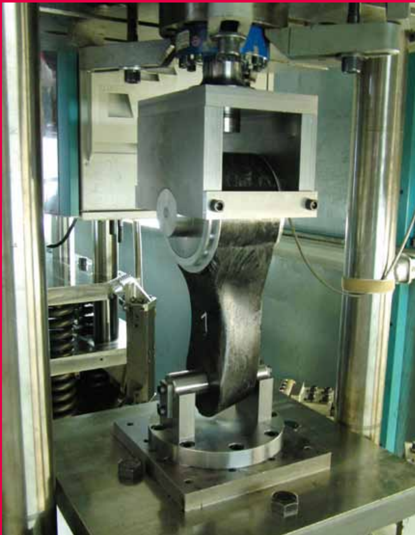
Rad-Lasteinleitungssystem in der dynamischen Prüfung (© SincoTec Test Systems GmbH)
