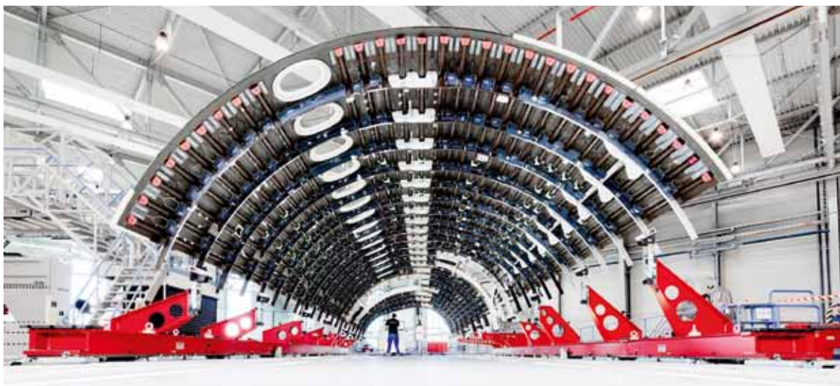
Von Premium AEROTEC gefertigte CFK-Rumpfschale
