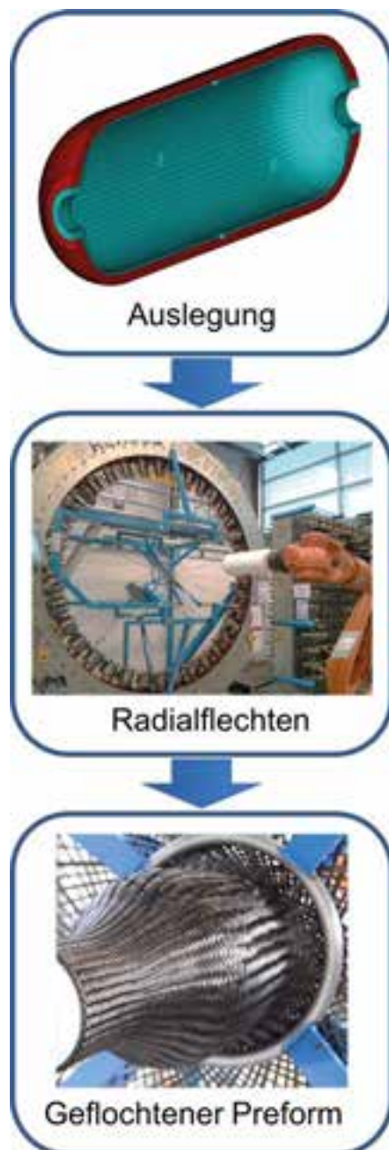
Abbildung: Das Radialflechtverfahren bietet hohes Potential zur automatisierten und ökonomischen Herstellung von FVK-Druckbehältern
