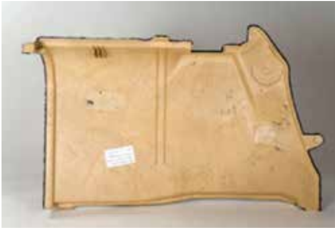
WPC Automotive Bauteil aus FASAL gespritzt WPC automotive component FASAL injected
