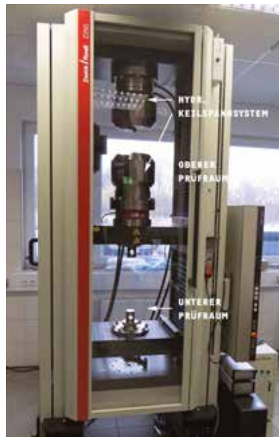
250kN Zugprüfmaschine mit zwei Prüfräumen 250kN tensile test machine with two test chambers
