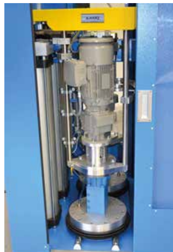
Neues Folgeplattensystem für materialverlustfreien Fasswechsel mit Vakuumentstützung
