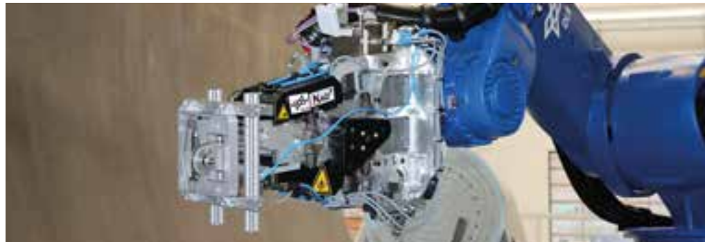
Abbildung 2: Smart Fiberplacement – das zusätzliche adaptronische System steigert die Präzision der robotergestützten Fertigungseinheit durch den eingebetteten piezoelektrischen Aktuator auch bei hochdynamischen Bewegungen
