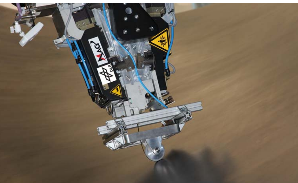
Abbildung 1: Fiberplacement-Legekopf der GroFi-Anlage im ZLP Stade erweitert um ein adaptives System zur Regelung der Andruckrolle gegen statische, quasi-statische und dynamische Abweichungen während der Faserablage
