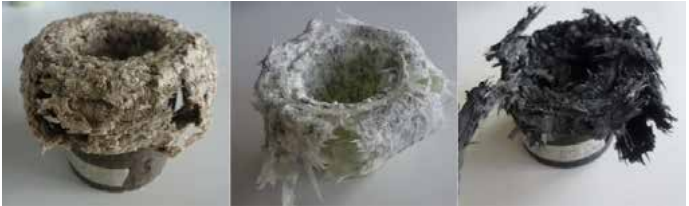
Plastische Verformung von Naturfaser-Composite Probe vs. GFK und CFK Probe als Vorstufe für ein Crash-Element
