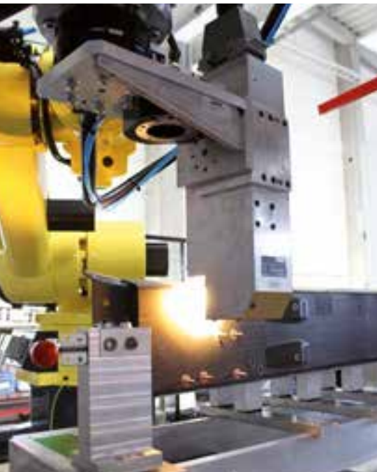
Vorwärmung der Klebstelle auf der Außenseite des Bauteils Bonding preparation on the outside of the part (pre-heating)
