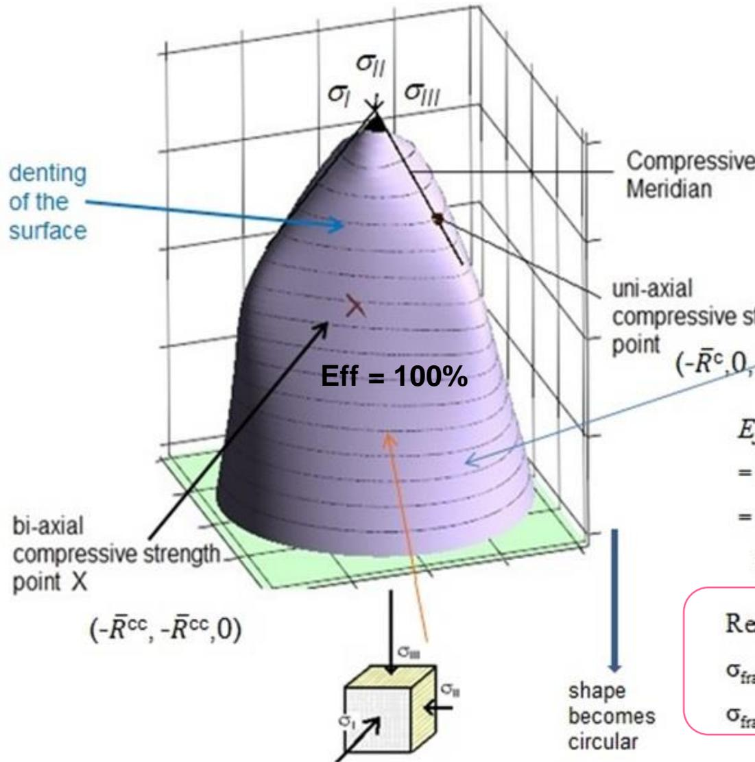
$$Eff^{NF} = c_{\Theta}^{NF} \cdot \frac{\sqrt{4J_2 \cdot \Theta^{NF} - I_1^2 / 3} + I_1}{2 \cdot \bar{R}^f}$$
