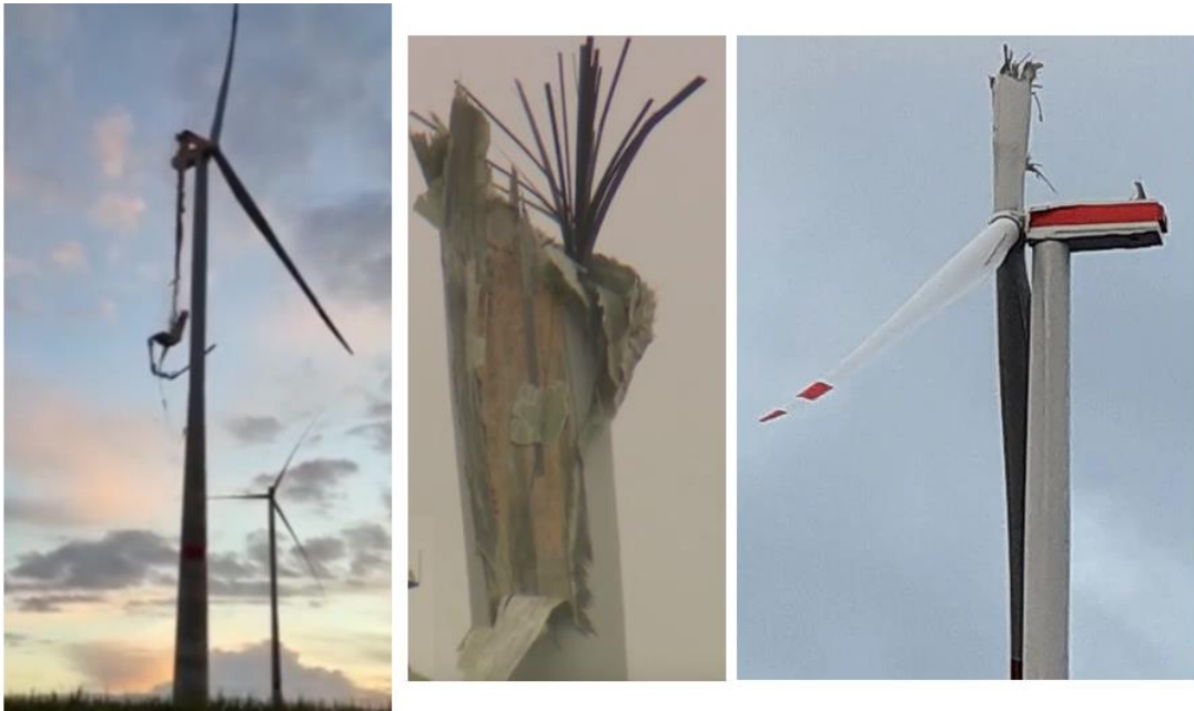
Fig. 1-2, Alfstedt:(links) Blatt beim Abfallen, (mittig) Bruchstelle mit CFK-Fasersträngen, (rechts) 'Stumpf' = Restanlage
