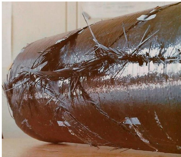
Fig. 5-2, CFK: (links) Rotor mit metallischer Innenauskleidung, (rechts) Geborstener Hochdrucktank [MAN-Technologie]
