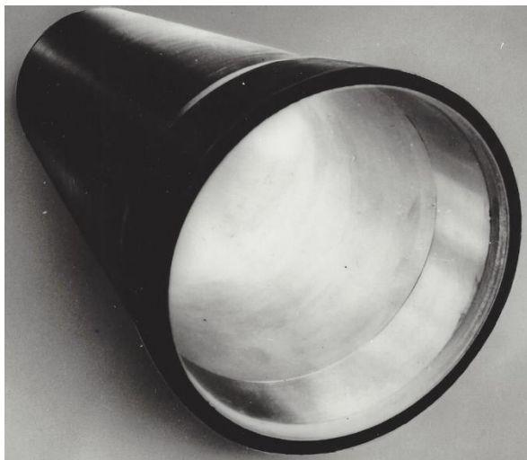
Fig. 5-2, CFK: (links) Rotor mit metallischer Innenauskleidung, (rechts) Geborstener Hochdrucktank [MAN-Technologie]
