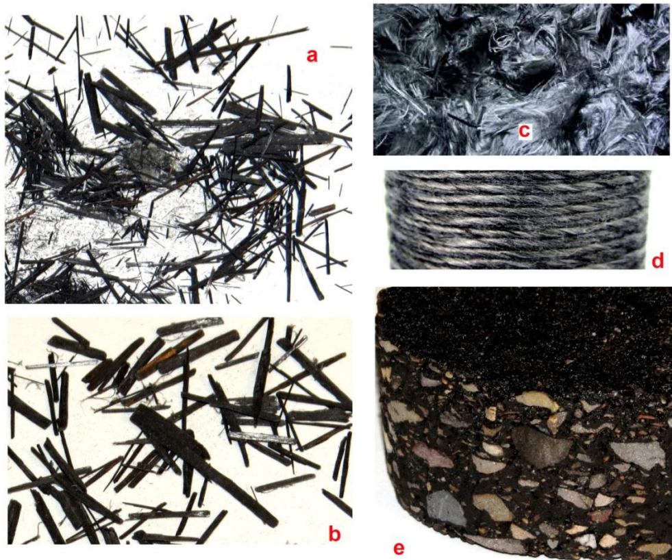
Fig.65: rCFK-Pins (a) und rCFK-Stäbchen (b), rCF - 'Gewölle' (c), rCF-Garn (d) und rCFK 'entsorgt' in 0.3%-rCFK-Asphalt (e) eingebaut nach ZTV Asphalt-StB 07/13. rCFRP-pins (a), rCFRP-rods (b), rCF- 'wool', rCF -yarn (d) and rCFRP disposed in asphalt (e) [Carbonwerke Weißgerber]
