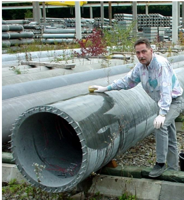
Fig.8: Freileitungsmast, im Spannbett gegen Biegung carbon-längsvorgespannt, Wanddicke: 40 mm. Overhead line mast, carbon-pretended in tension bed, wall thickness 40 mm [Fa. SACAC mit EMPA, 2001]
