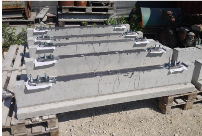
Fig.45: Vorspannungskonzept: Versuchsbalken zur Vorspannung mit CFK-Stäben \varnothing 6 und \varnothing 8 mm in Schlitten. Pre-tensioning concept: test beam, CFRP rods \varnothing 6 and \varnothing 8 mm in slits (NSM-PT) System. [HPTL- DTU, Technische Universität Kopenhagen]
