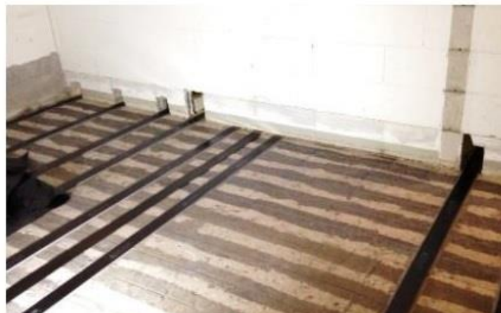
Fig.46: Nach-Vorspannungskonzept / Post-tensioning concept. Versuchsbalken zur Vorspannung mit CFK-Lamellen 20 mm x 3 mm in Schlitten. Test beam for pre-tenioning with CFRP-lamellas 20 mm x 3 mm in slits. [HPTL- FiS = Force in Slit, mit Fa. Züblin und Fa. Paul Vorspanntechnik, TU Wien, NSM-PT System]
