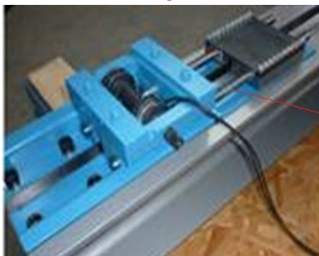
Fig.45: Vorspannungskonzept: Versuchsbalken zur Vorspannung mit CFK-Stäben \varnothing 6 und \varnothing 8 mm in Schlitten. Pre-tensioning concept: test beam, CFRP rods \varnothing 6 and \varnothing 8 mm in slits (NSM-PT) System. [HPTL- DTU, Technische Universität Kopenhagen]
