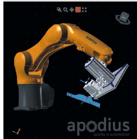
Die AVS-Software bietet gleichzeitige Echtzeit-Virtualisierung des Messvorgangs und den Soll-Ist-Vergleich der aufgenommenen und angezeigten Ist-Geometrie mit den hinterlegten CAD-Daten.
